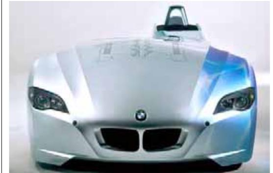
Der BMW H2R, so heißt das Rekordauto, ist mit einem Zwölfzylindermotor mit sechs Litern Hubraum bestückt und leistet mehr als 285 PS (210 kW). Das reicht für eine Beschleunigung von 0 auf 100 km/h in rund sechs Sekunden und eine Höchstgeschwindigkeit von 302,4 km/h. Quelle: Spiegel - online
