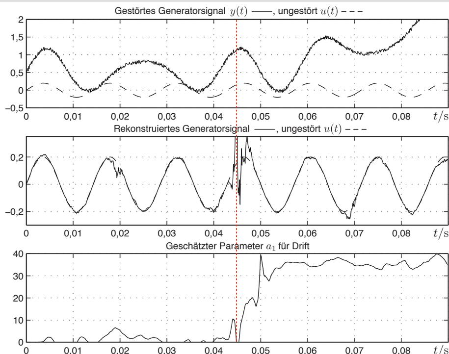
Überwachung eines Generatorsignals mit sprunghafter Änderung des Parameters  $a_1$  (Drift) bei  $t = 0,045$ .
