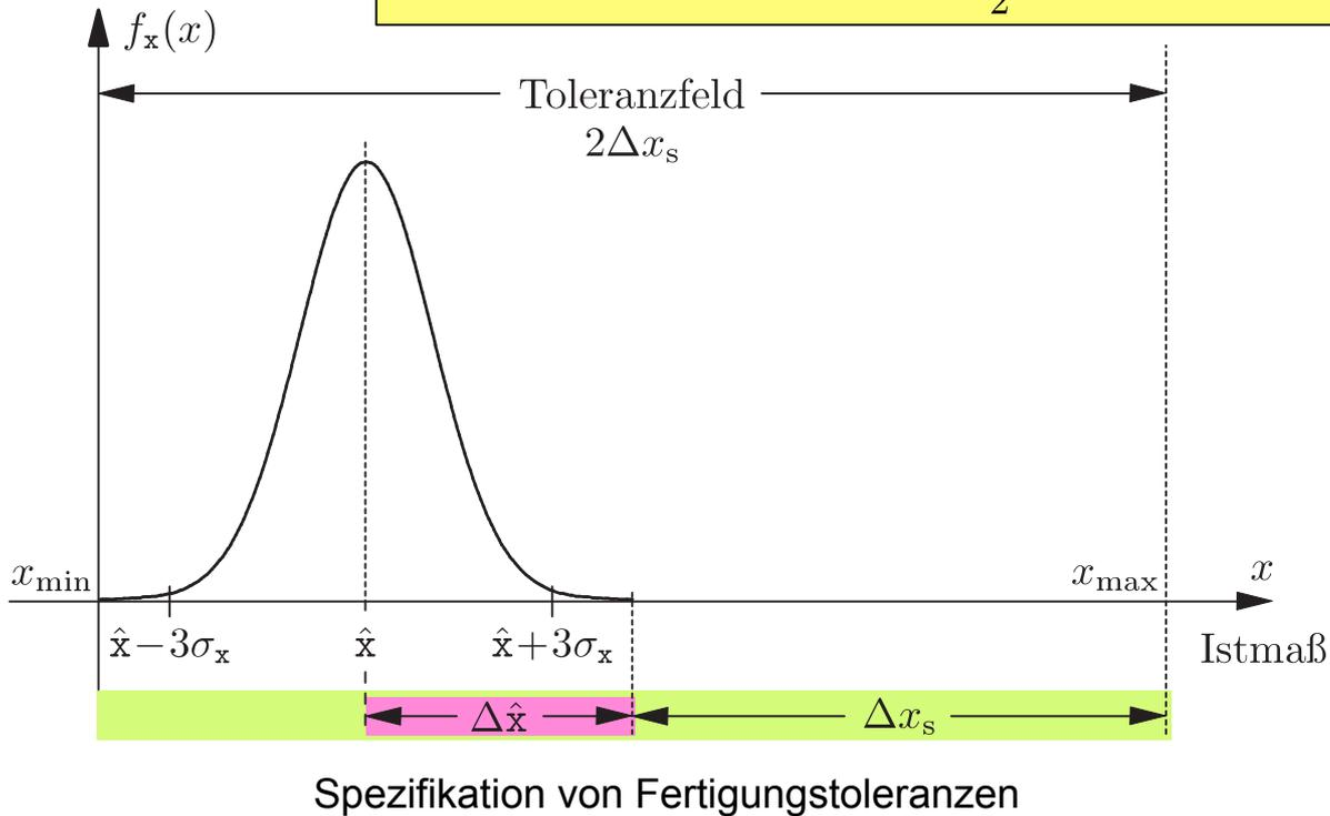
Spezifikation von Fertigungstoleranzen
