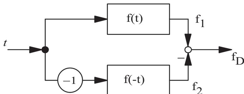
Abbildung 1: Parallelschaltung zweier Meßwertaufnehmer.
