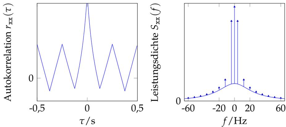
Abbildung 7: Autokorrelation und Autoleistungsdichte von  $x(t)$ .
