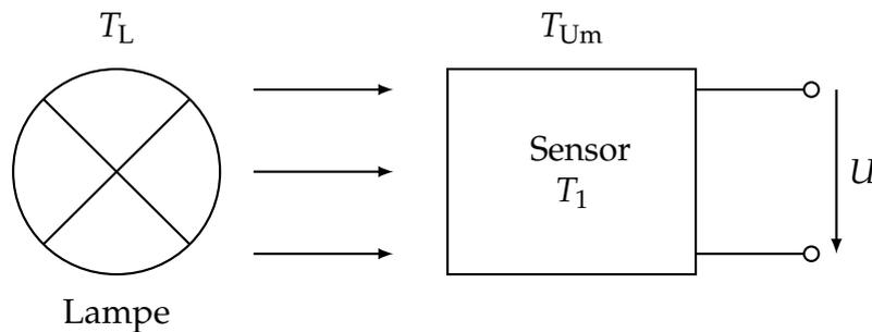
Abbildung 2: Messsystem des Temperatursensors.
