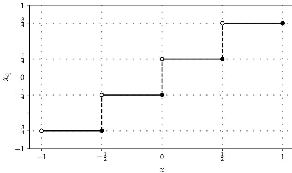
Abbildung 2: Kennlinie des verwendeten Quantisierers.
