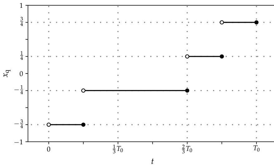
Abbildung L3: Quantisiertes Signal  $x_q(t)$ .
