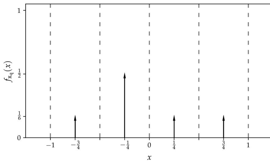
Abbildung L4: Amplitudendichte des quantisierten Signals  $x_q(t)$ .
