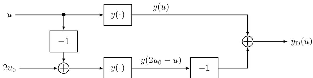
Abbildung L1: Verschaltung der gegebenen Blöcke zur Differenzkennlinie.
