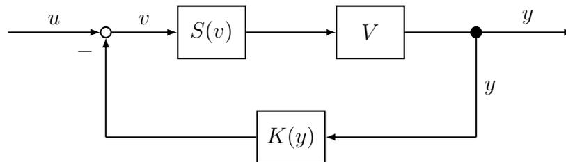
Abbildung L1: Blockschaltbild der Gegenkopplung.
