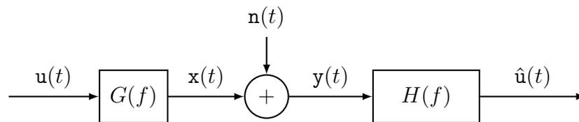
Abbildung L2: Blockdiagramm des Wiener-Filters
