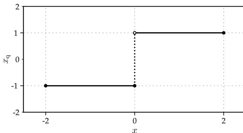
Abbildung L3: Mögliche ideale Quantisierungskennlinie für das Signal  $r(t)$ .
