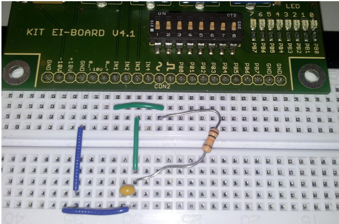
Abbildung L1: RC-Tiefpass-Schaltung.
