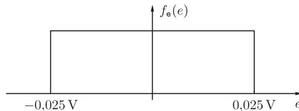
Abbildung 1: Wahrscheinlichkeitsdichte des gleichverteilten Messfehlers.
