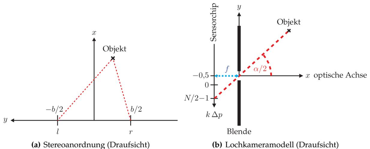
**Abbildung 3:** Einfaches Stereokameramodell.
