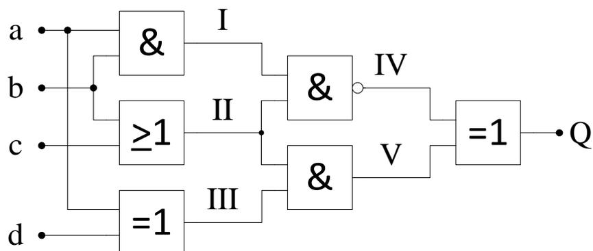
Abbildung 5-1: Schaltnetz der Funktion  $f(d,c,b,a) = Q$
