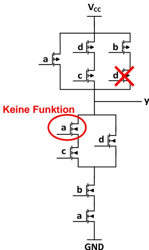
Abbildung 8-2: Fehlerhafte Schaltung
