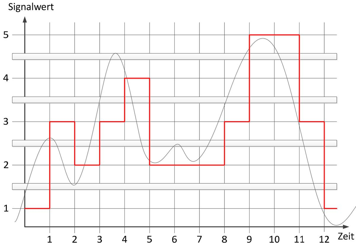
Abbildung 1-1: Analoges Signalverlauf
