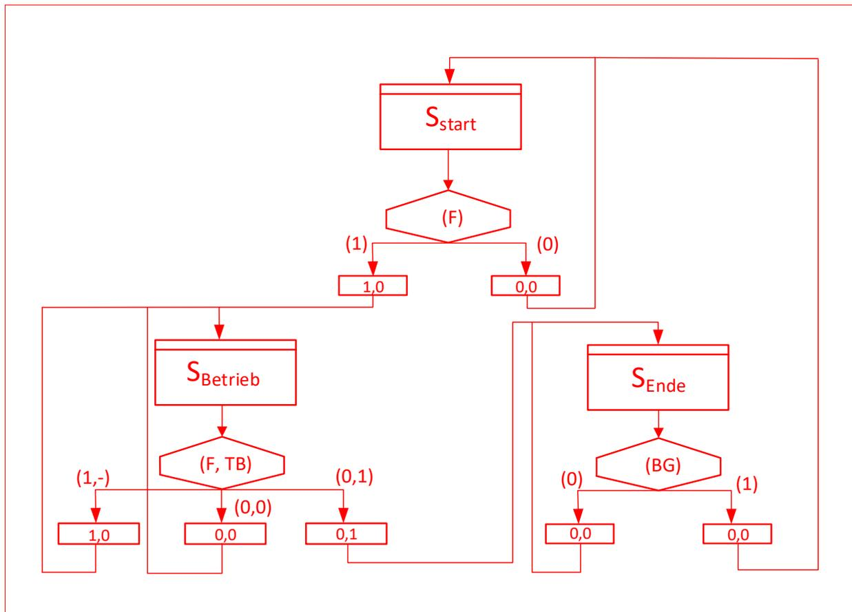
Abbildung 7.1: Ablaufdiagramm des vereinfachten Leergutautomaten
