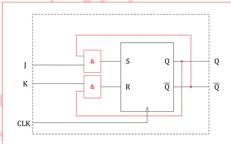
Abbildung 7.3: RS-Flipflop zur Erzeugung eines JK-Flipflops
