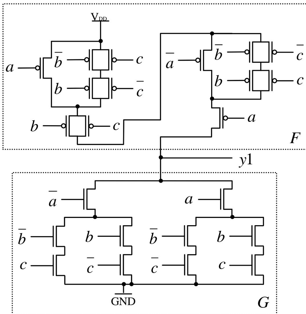
Abbildung 4–1: Fehlerhaftes CMOS-Schaltnetz
