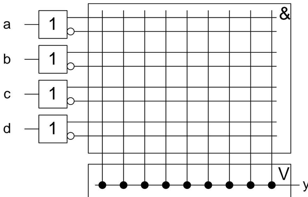
Abbildung 2–1: PAL-Schaltnetz
