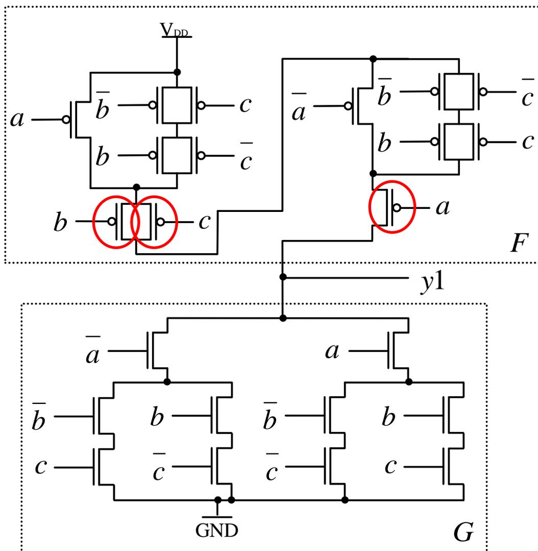
Abbildung 4–1: Fehlerhaftes CMOS-Schaltnetz
