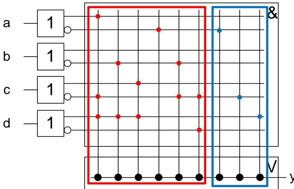
Abbildung 2–1: PAL-Schaltnetz
