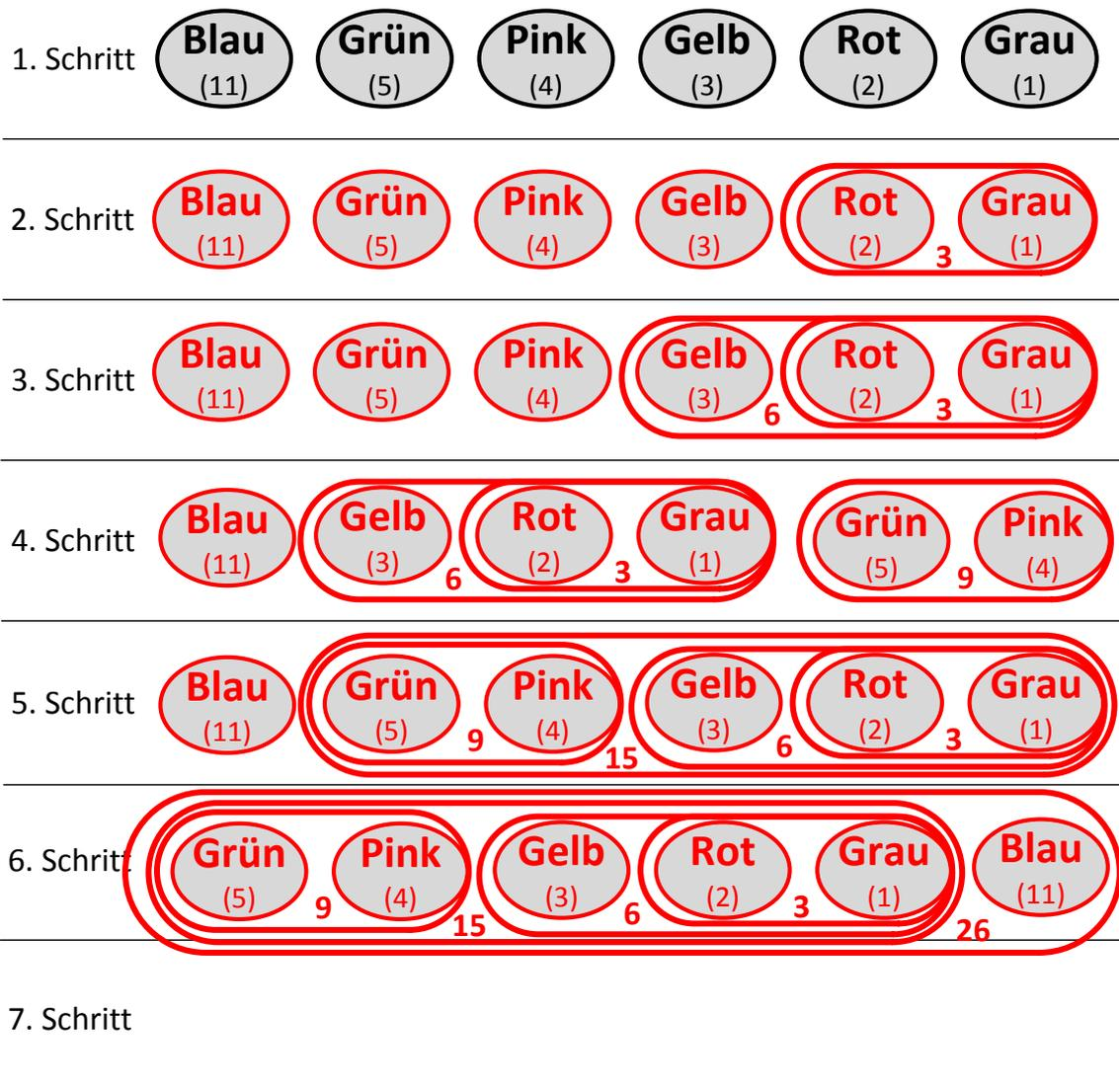
**Abbildung 6-1: Schrittweise Huffman-Codierung**
