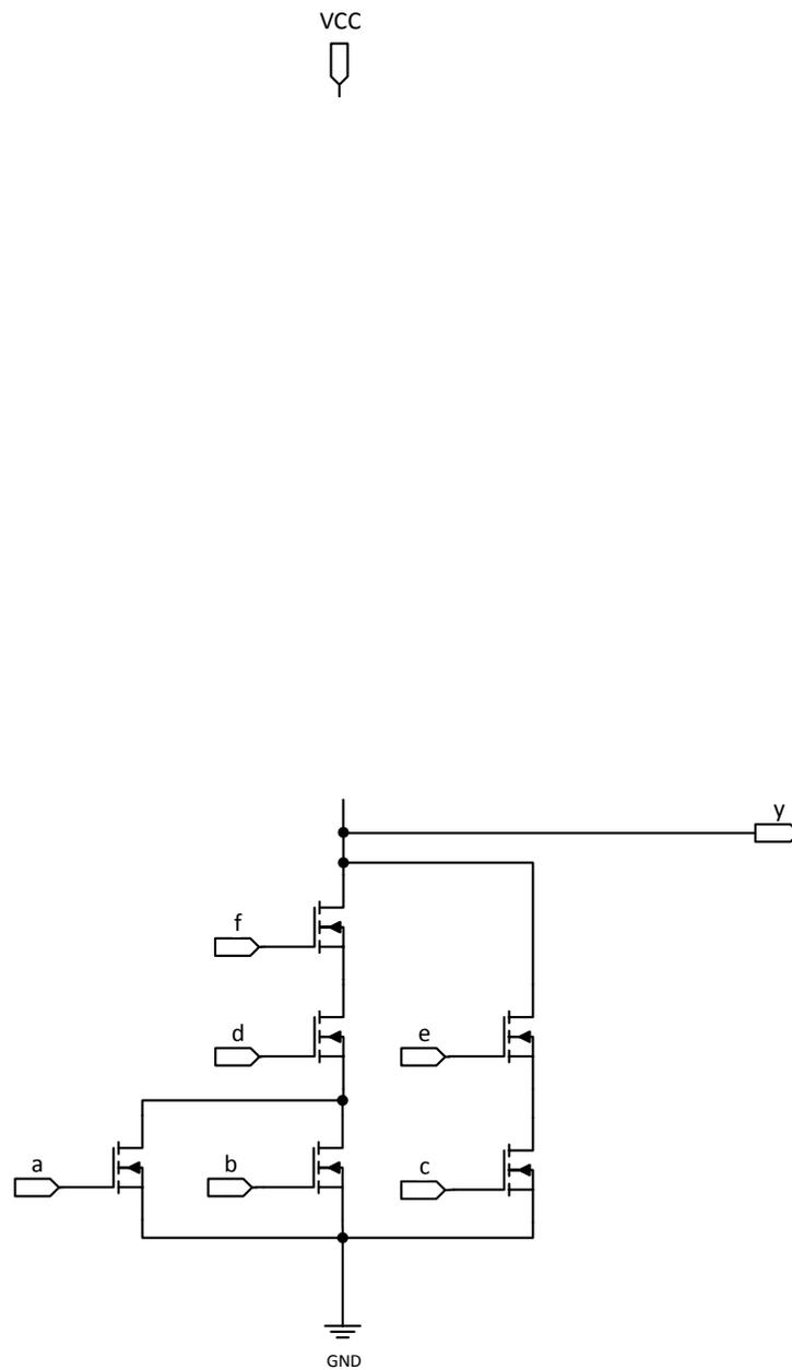
Abbildung 8.3: Entwickelte CMOS Schaltung
