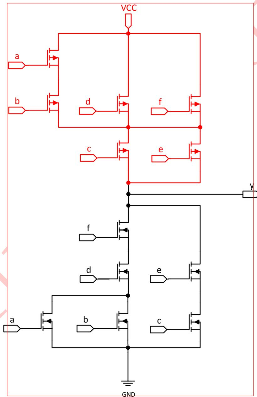
Abbildung 8.3: Entwickelte CMOS Schaltung
