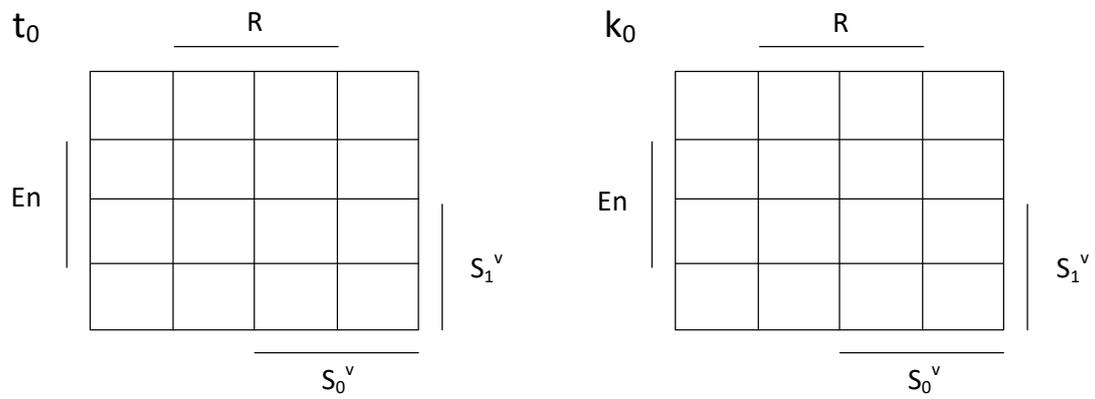
Abbildung 6.3: Symmetriediagramme zur bestimmung der Ansteuerfunktionen
