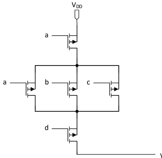
Abbildung 6.1: CMOS Pullup-Netz
