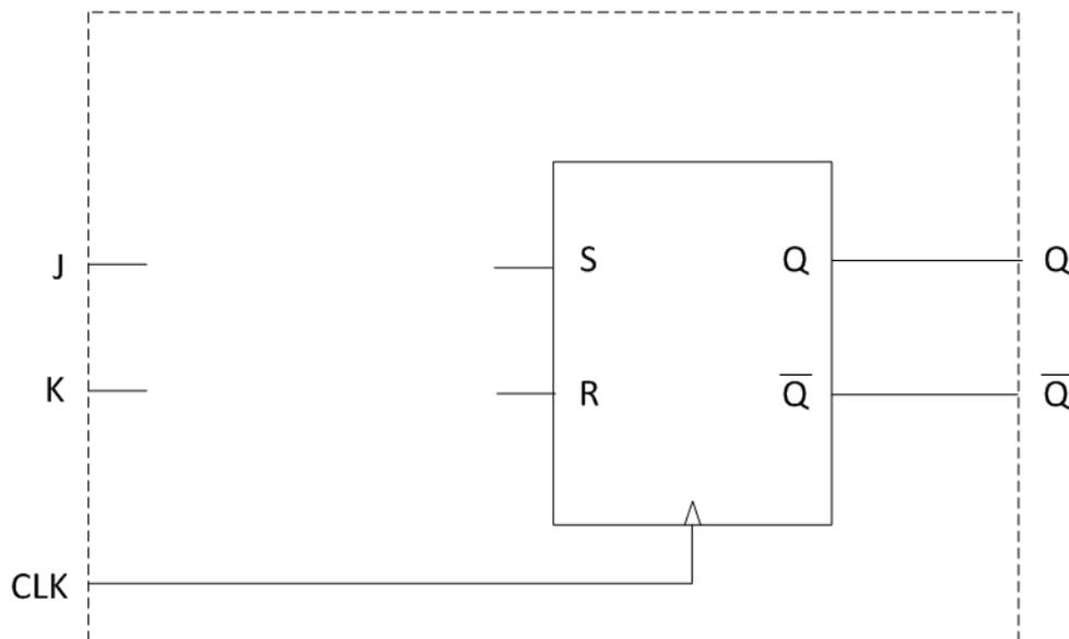
Abbildung 8.3: RS-Flipflop zur Erzeugung eines JK-Flipflops
