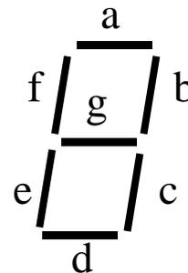
Falls die Ziffern  $0, \dots, 9$  binär kodiert an den Eingängen anliegen, soll die Ziffer entsprechend in der Sieben-Segment-Anzeige erscheinen. Beispiel: der 0 entspricht  $w=x=y=z=0$ , die Ausgänge  $a, b, c, d, e, f$  müssen dann zur Anzeige der 0 den Wert 1 aufweisen.
