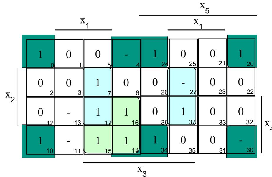
$$y = \overline{(x_2 \& x_1)} \vee (x_3 \& x_4 \& \overline{x_5}) \vee (x_1 \& x_2 \& x_3)$$
