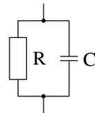
$$\underline{Y} = \frac{1}{R} + j \omega C \Rightarrow \text{mögliche Lösung}$$
