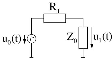
Abbildung 6.1: Ersatzschaltbild für die einlaufende Welle
