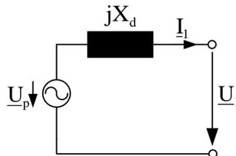
*Abbildung 13.1: vereinfachtes Ersatzschaltbild eines Turbogenerators*
