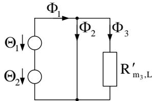
Mit zunehmendem  $\mu_r$  verlagert sich der magnetische Fluss in den mittleren Schenkel. Eine Vergrößerung des Luftspaltes verstärkt diesen Effekt zusätzlich.
