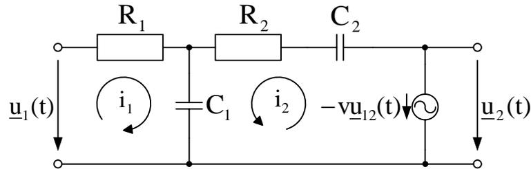
Abbildung 8.1: Ersatzschaltbild der Operationsverstärkerschaltung
