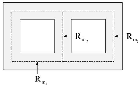
Abbildung 2.2: Elemente des magnetischen Kreises
