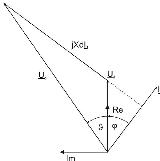
*Abbildung 13.2: Zeigerdiagramm: 1cm  $\hat{=}$  2 kV, 1cm  $\hat{=}$  2 kA*
