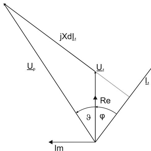
*Abbildung 12.2: Zeigerdiagramm: 1cm  $\hat{=}$  2kV, 1cm  $\hat{=}$  2kA*
