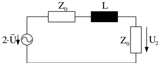
Abbildung 7.1: Ersatzschaltbild: einlaufende Welle in die zweite Leitung (Vorschlag 1)
