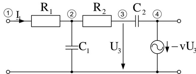
Abbildung 9.2: Ersatzschaltbild für Knotenpotentialanalyse
