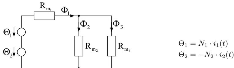
Abbildung 2.1: magnetisches Ersatzschaltbild
