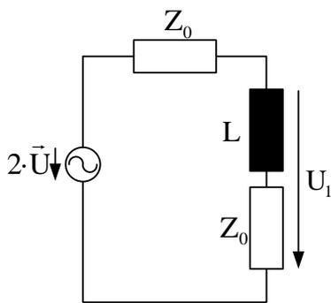
Abbildung 7.2: Ersatzschaltbild: reflektierte und in die erste Leitung zurücklaufende Welle (Vorschlag 1)
