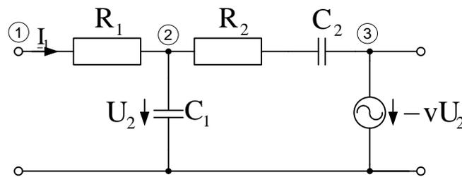
Abbildung 8.2: Ersatzschaltbild für Knotenpotentialanalyse
