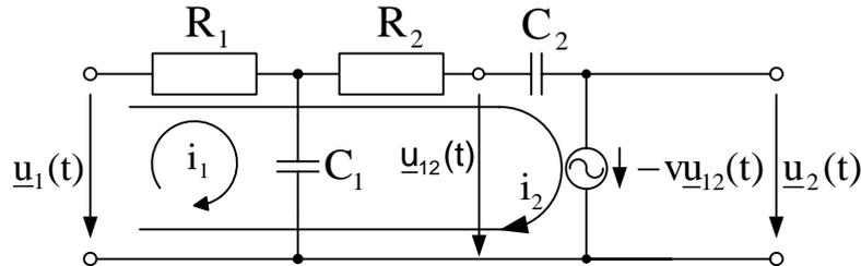
Abbildung 9.1: Ersatzschaltbild der Operationsverstärkerschaltung
