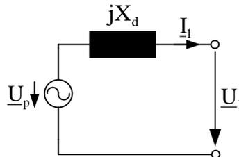
*Abbildung 12.1: Ersatzschaltbild eines Turbogenerators*
