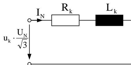
Abbildung 14.1: Ersatzschaltbild nur mit Längsimpedanzen
