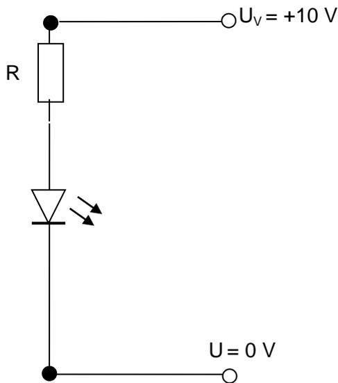
6.2 Die Grenze für den ausgeschalteten Modus ist der Schwellstrom, da die Laserdiode erst ab diesem Strom anfängt überhaupt zu leuchten und die Diode nicht unterhalb des Schwellstroms betrieben werden soll. Der Schwellstrom liegt laut Tabelle oder laut Grafik bei  $I_{th} = 3,5\text{ mA}$ .
