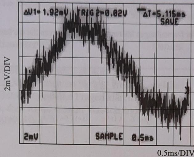
Bild 5.8 Hochauflösendes Oszillogramm der Ausgangsspannung des Subtrahierers mit einer Abtastrate von 100MHz.
