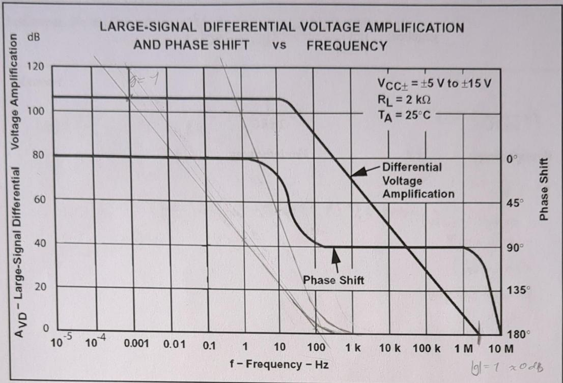
**Bild 5.2** Differenzverstärkung und Phasengang TL071
