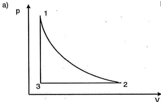
b)  $T_2 = T_1$  da 1→2 isotherm
