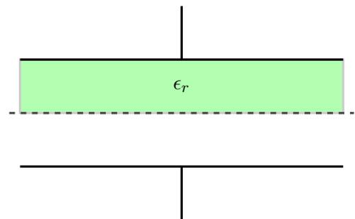
wenn bei konstanter Ladung  $Q$  das Volumen zwischen den Platten anschließend wie skizziert zur Hälfte mit einem Dielektrikum mit der Dielektizitätszahl  $\epsilon_r$  gefüllt wird?
