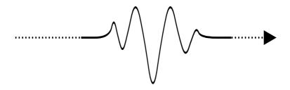
Wir betrachten ein Wellenpaket, das sich mit konstanter Geschwindigkeit in eine Richtung ausbreitet. Es besteht aus einer Mischung von Sinuswellen unterschiedlicher Frequenzen. Ist die Phasengeschwindigkeit c frequenzabhängig, so "entwirren" sich die verschiedenen Frequenzen im Laufe der Zeit; das ist Dispersion. Das Wellenpaket verbreitert sich dadurch. Die Geschwindigkeit, mit der sich das Maximum des Wellenpaketes ausbreitet, heiß Gruppengeschwindigkeit.
