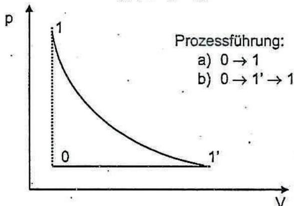
S ist Zustandsgröße: mit a)  $\Rightarrow \Delta S = \frac{p_0 V_0}{T_0} \cdot \frac{5}{2} \cdot \ln\left(\frac{T_1}{T_0}\right) = 0,83 \frac{J}{K}$
