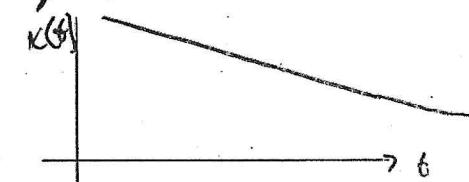
Gleichgewichtslage wird am schnellsten erreicht im Fall b) (aperiod. Grenzfall) → wichtig für Zeiger von Messgeräten, Waagen etc.
