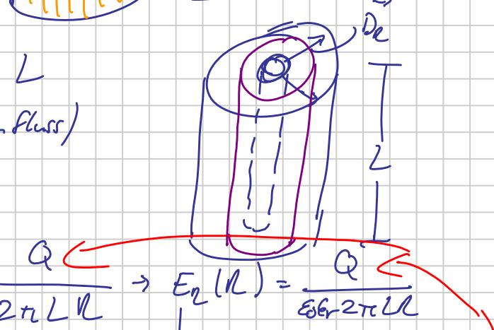
Schraffierte Kondensator mit doppelter Länge L
