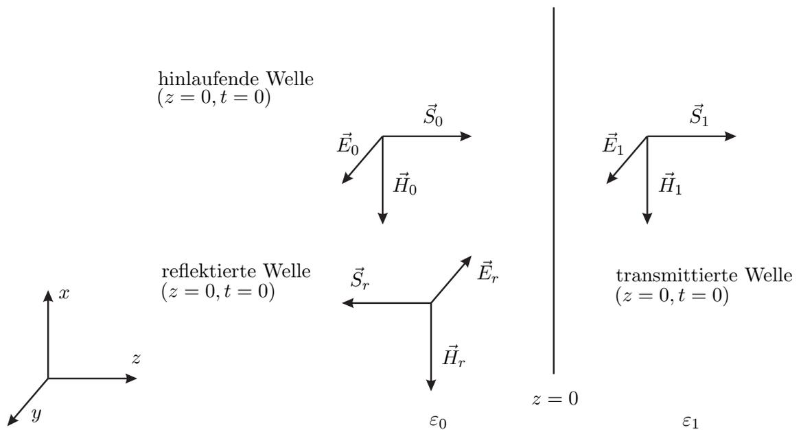
Abbildung 1: Einlaufende, reflektierte und transmittierte Welle. Die Skizze dient nur dazu den Orientierungssinn (über  $\vec{S} = \vec{E} \times \vec{H}$ ) der Vektoren jeweils einer Welle zu bestimmen. (Z.B.  $H_0 = -\frac{1}{\Gamma_0} E_0$ ). Jedoch kann noch keine Aussage gemacht werden ob  $E_0$  und  $E_r$  in die selbe oder entgegengesetzte Richtung zeigen. Dies ergibt sich erst aus der Rechnung.
