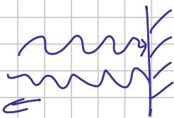
Überlagerung: stehende Welle mit Schwingungsamplituden und -frequenzen
