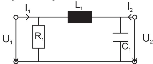
Bestimmen Sie die Y-Parameter des 2-Tors und zeichnen Sie entsprechende Ersatzschaltbilder für alle  $Y_{xy}$  mit sämtlichen Vereinfachungen.
