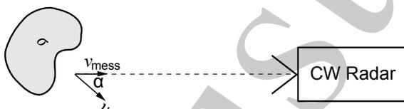
Gemessen wird der Anteil der Geschwindigkeit, der sich senkrecht auf den Radar zubewegt. Diese gemessene Geschwindigkeit hängt vom Winkel  $\alpha$  ab.
