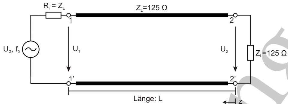
b) Gegeben sind folgende Betriebsdaten der Leitung: Länge  $L = 1,5\text{m}$ , Dämpfungsbelag  $\alpha = 0,46/\text{m}$ , Wellenlänge  $\lambda = 1\text{m}$ . Skizzieren Sie die Verläufe der Spannungsamplituden der hinlaufenden, rücklaufenden und resultierenden Welle ( $|U_H(z)|$ ,  $|U_R(z)|$ ,  $|U(z)|$ ) entlang der Leitung ( $z = 0 \dots 1,5\lambda$ ). Die Amplitude der hinlaufenden Welle bei  $z = 1,5\lambda$  sei  $2\text{V}$ .
