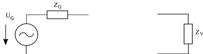
Ein Verbraucher mit der Impedanz  $Z_V = (75 + j100) \Omega$  soll an eine Quelle mit der Impedanz  $Z_Q = 50 \Omega$  reflexionsfrei angeschlossen werden. Zur Verfügung stehen Ihnen folgende Elemente:
