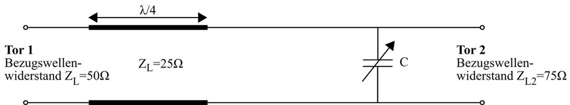
Welche Kurve durchläuft der Streuparameter  $S_{11}$ , wenn  $C$  von  $0 \dots \infty$  durchgestimmt wird?
