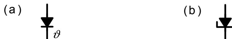
**Abbildung 7.1:** (a) Temperaturabhängige Diode, (b) Zener-Diode oder Z-Diode. basierend auf dem Zener-Effekt als auch auf dem Lawinendurchbrucheffect.
