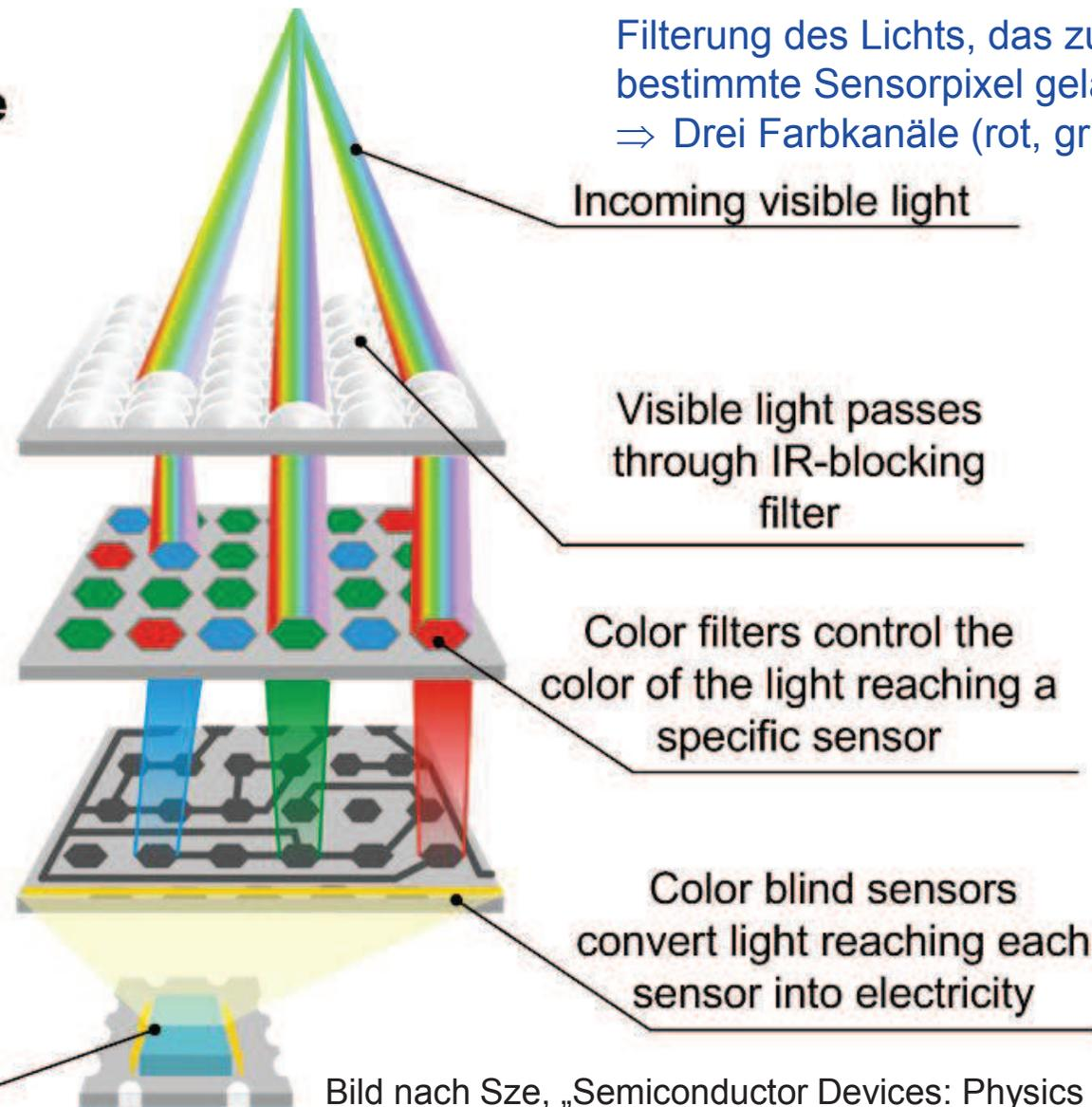
Filterung des Lichts, das zu einem bestimmte Sensorpixel gelangt
