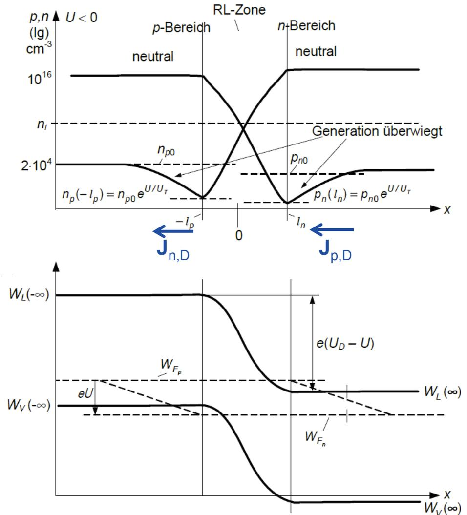
Das bisher besprochene ideale Modell, auch Shockley-Modell genannt, gilt in recht guter Näherung für Germanium-Dioden. Bei Si- und noch stärker bei GaAs- Dioden ergeben sich jedoch **Abweichungen der realen gegenüber der idealen Kennlinie**:
