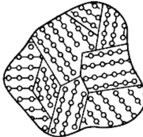
**Polykristalliner Festkörper:** Besteht aus kleinen Einzelkristallen (Kristalliten) besteht, die durch Korngrenzen voneinander getrennt werden.
