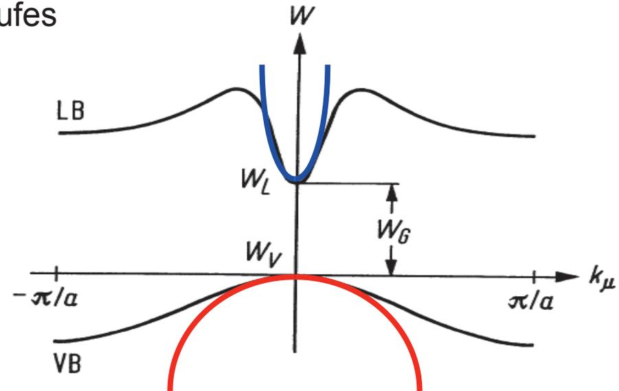
⇒ **Kombination der beiden Modelle:** Zustandsdichte für das Leitungs- und Valenzband unter der Annahme einer parabolischen Annäherung des Bandverlaufes
