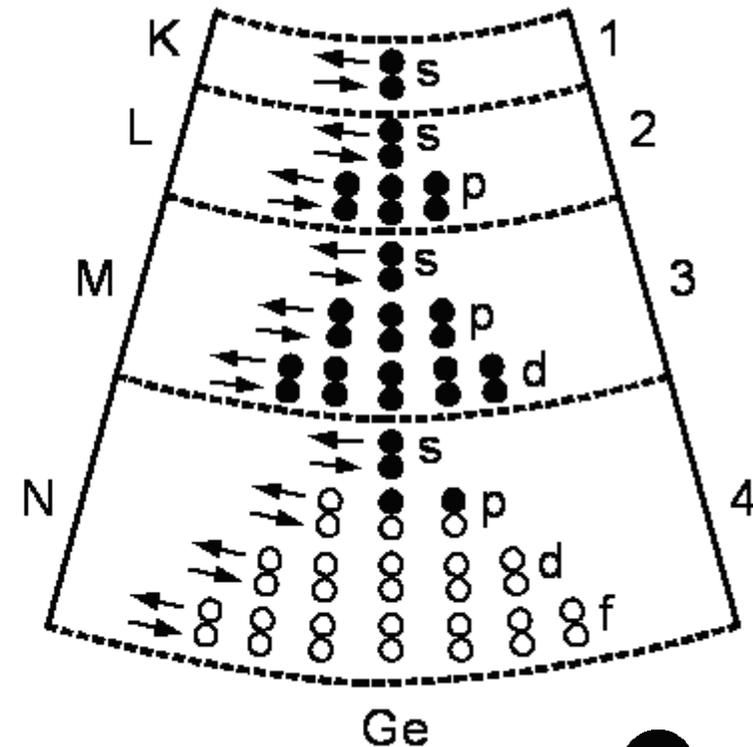
**Kovalente Bindungen:** Vollständig aufgefüllte Elektronenschalen stellen einen günstigeren Energiezustand dar („Edelgas-Zustand“); dies kann durch „gemeinsame Nutzung“ von Elektronen erreicht werden.
