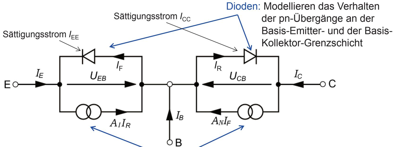
**Dioden:** Modellieren das Verhalten der pn-Übergänge an der Basis-Emitter- und der Basis-Kollektor-Grenzschicht
