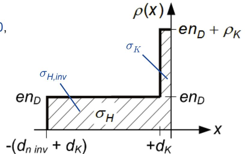
In realen Strukturen muss zunächst noch eine sog. **Flachbandspannung**  $U_{FB}$  über den Isolator angelegt werden, damit sich der Flachbandfall einstellt. Die Flächenladungsdichte im Inversionskanal lässt sich dann schreiben als:
