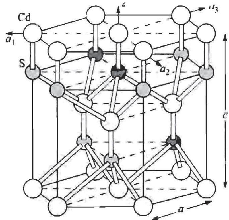
**Wurtzit-Struktur,** bestehend aus zwei Hexagonalgittern, die gegeneinander um  $1/3$  des Ebenenabstandes in Richtung der Längsachse verschoben sind, typisch für II-VI-Halbleiter wie CdS, ZnS etc.
