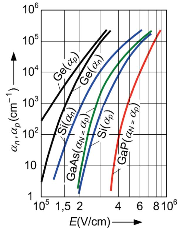
Silizium bei 30 V/ $\mu\text{m}$ : Nur Elektronen ionisieren
