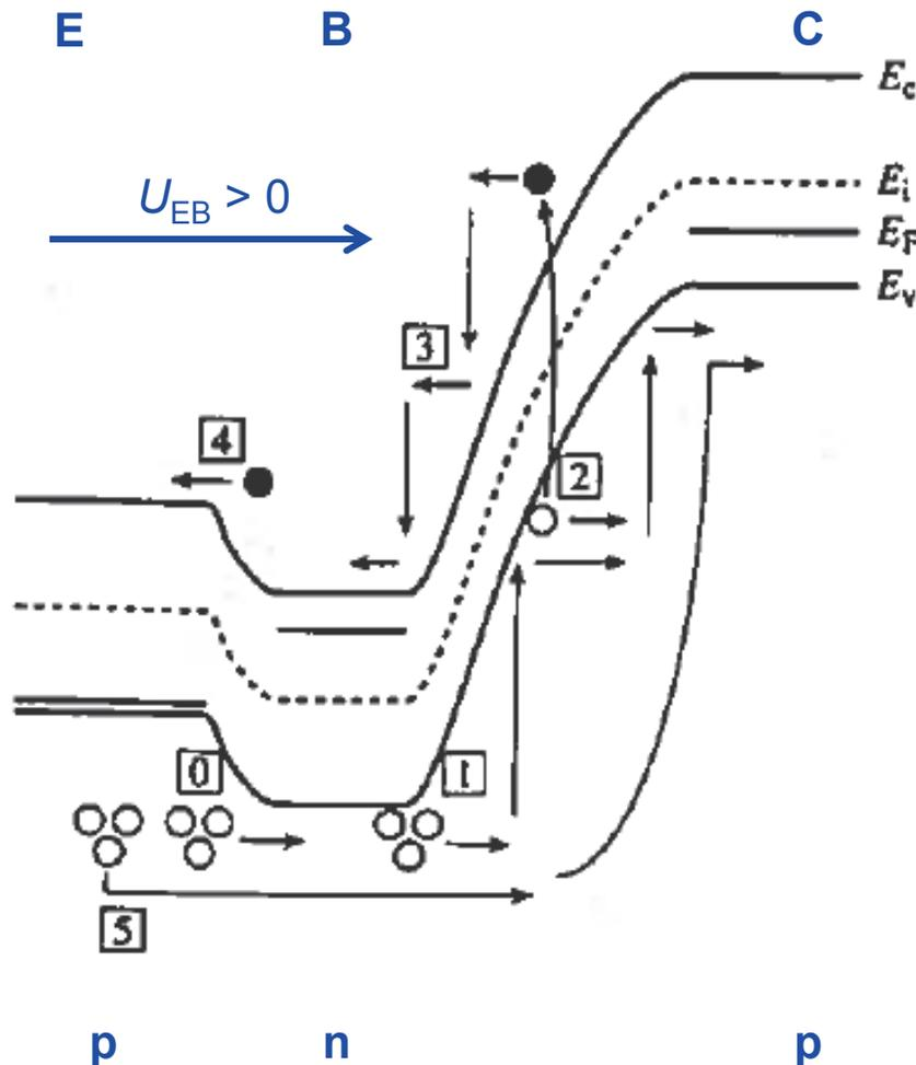
0. **Starke Löcherinjektion** (Vorwärtsstrom des  $E$ - $B$ -Überganges!) aus dem Emitter in die Basis ...
