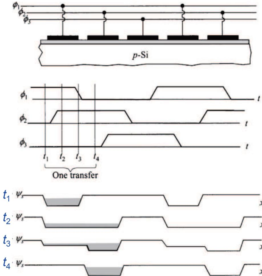
Ausleseprinzip von CCD-Sensorarrays:
