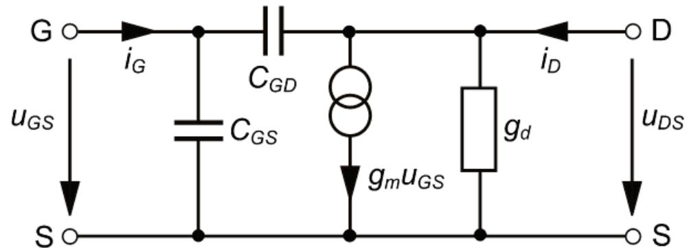
**Kleine Schaltspannung am Gate:** Betrachte Spannungshub  $\Delta U_{GS}$  der für eine bestimmte Änderung der Flächenladungsdichte  $\sigma_K$  im Kanal benötigt wird:
