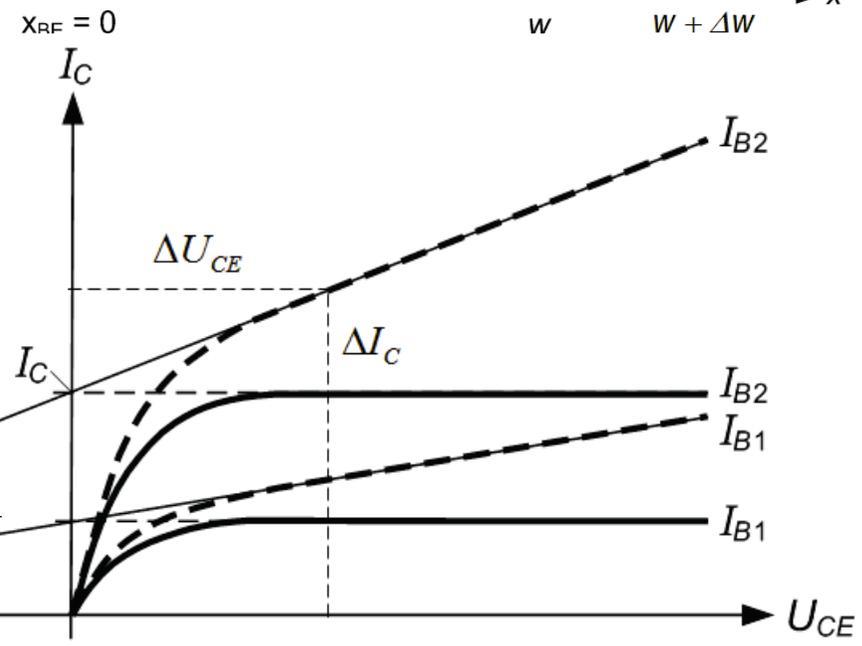
2. Änderung des Basis-Rekombinationsstromes  $I_{BB}$  mit  $U_{CB}$  durch Erhöhung der Steigung des Ladungsträgerprofils in der Basis:
