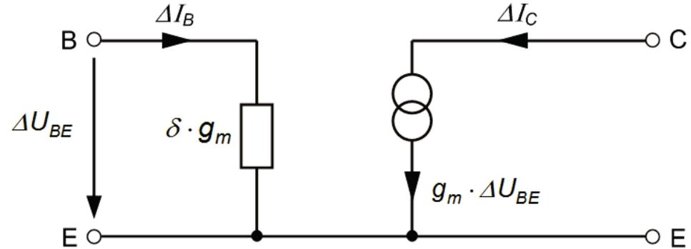
Kleinsignal-Schaltungsanalyse im Niederfrequenz-Fall:
