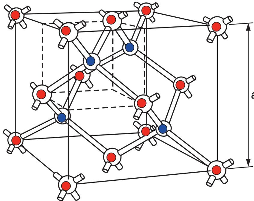
**Zinkblendestruktur:** Eine gleiche Anzahl von **Ga** und **As** Atomen sind so auf einem Diamantgitter verteilt, dass jedes Atom vier Nachbarn der jeweils anderen Art hat; typisch für III-V-Halbleiter wie GaAs, InP, InGaAsP usw.
