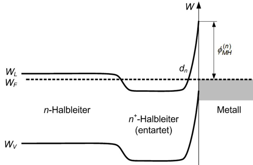
**Problem bei Metallkontakten:** Dotierung des Halbleiters an der Kontaktstelle durch Eindiffusion der Metall-Atome; bei Kontakten von  $n$ -Silizium mit Al (Akzeptor!) führt die Eindiffusion von Al beispielsweise zum „Umdotierung“ des Halbleiters.
