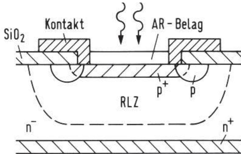
Planare Si-Photodiode, Einstrahlung von oben
