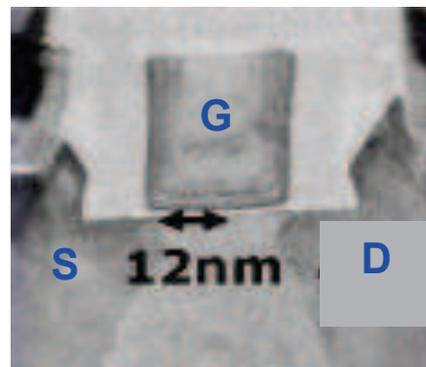
**Heute:** Feldeffekt-Transistoren mit Gate-Längen von ca. 20 nm
