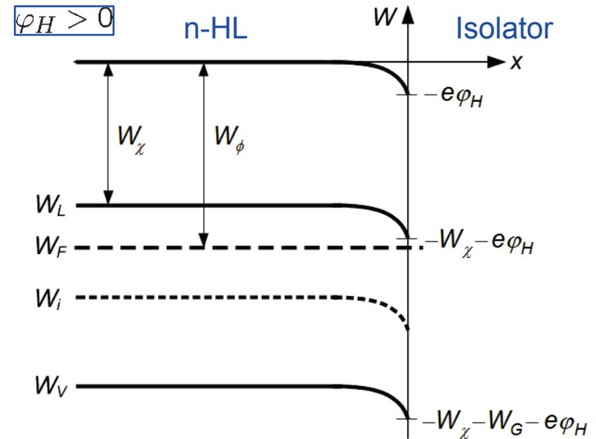
Kleinsignal-Kapazitätsbelag: Interpretiere Gesamtkapazität C als Reihenschaltung der Kapazität  $C_H$  der Anreicherungsrandschicht und der Kapazität  $C_I$  der Isolatorschicht
