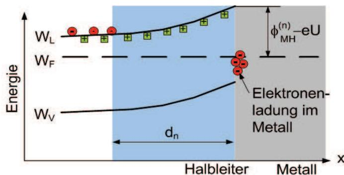
Spannung in Sperrrichtung ( $U < 0$ ): Potentialbarriere wird größer; kein nennenswerter Elektronenfluss
