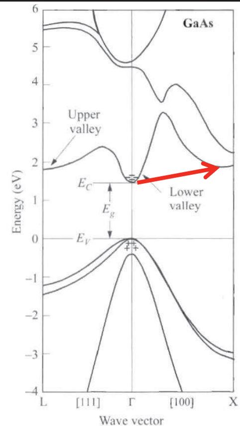
Erinnerung: Negative differentielle Driftgeschwindigkeit von Elektronen in GaAs durch Streuung von Elektronen in ein zweites Minimum des LB, das eine höhere effektive Masse aufweist.
