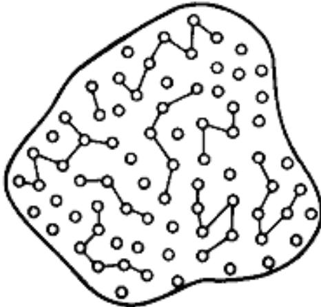
**Amorpher Festkörper:** Atome oder Molekülen bilden keine geordneten Strukturen, sondern ein unregelmäßiges Muster (lediglich Nahordnung, keine Fernordnung)
