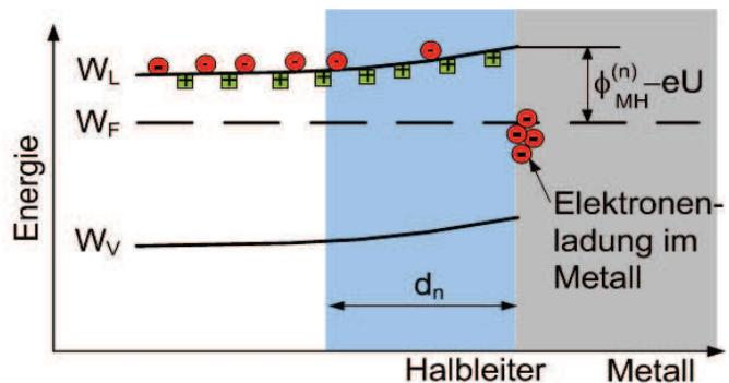
Spannung in Durchlassrichtung ( $U > 0$ ): Potentialbarriere wird kleiner; Elektronen gelangen vom Halbleiter ins Metall
