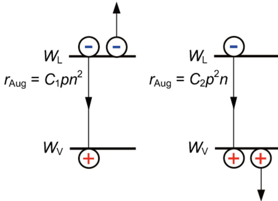
Rekombination unter Energie-Abgabe an ein Elektron im Leitungsband oder an ein Loch im Valenzband.
