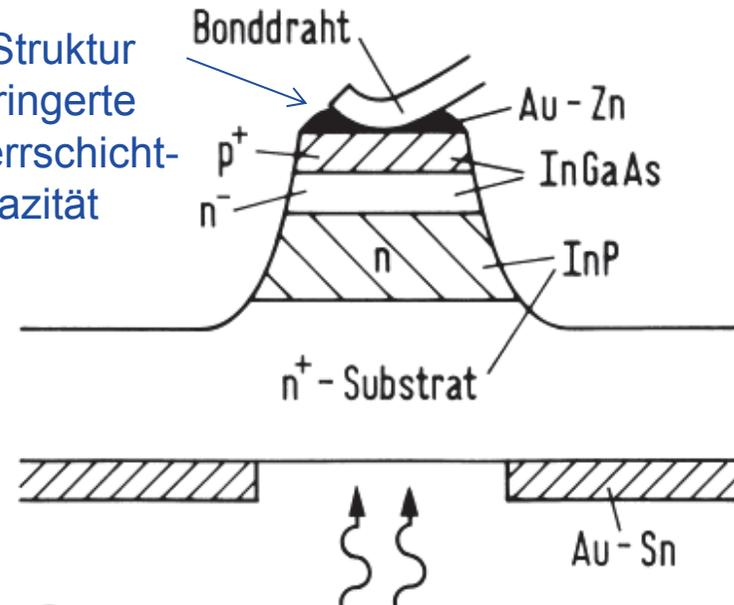
Photodiode mit InGaAs/InP-Heterostruktur; Beleuchtung durch das InP-Substrat ( $W_G > \hbar\omega$ )
