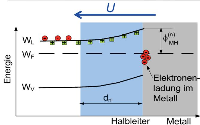
Keine äußere Spannung ( $U = 0$ ): Elektronen im Halbleiter und Metall sind durch eine Potentialbarriere voneinander getrennt
