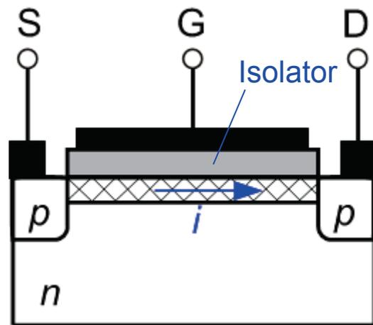
Metal-Insulator-Semiconductor FET (**MISFET**) bzw. Insulated-Gate Field Effect Transistor (**IGFET**) :
