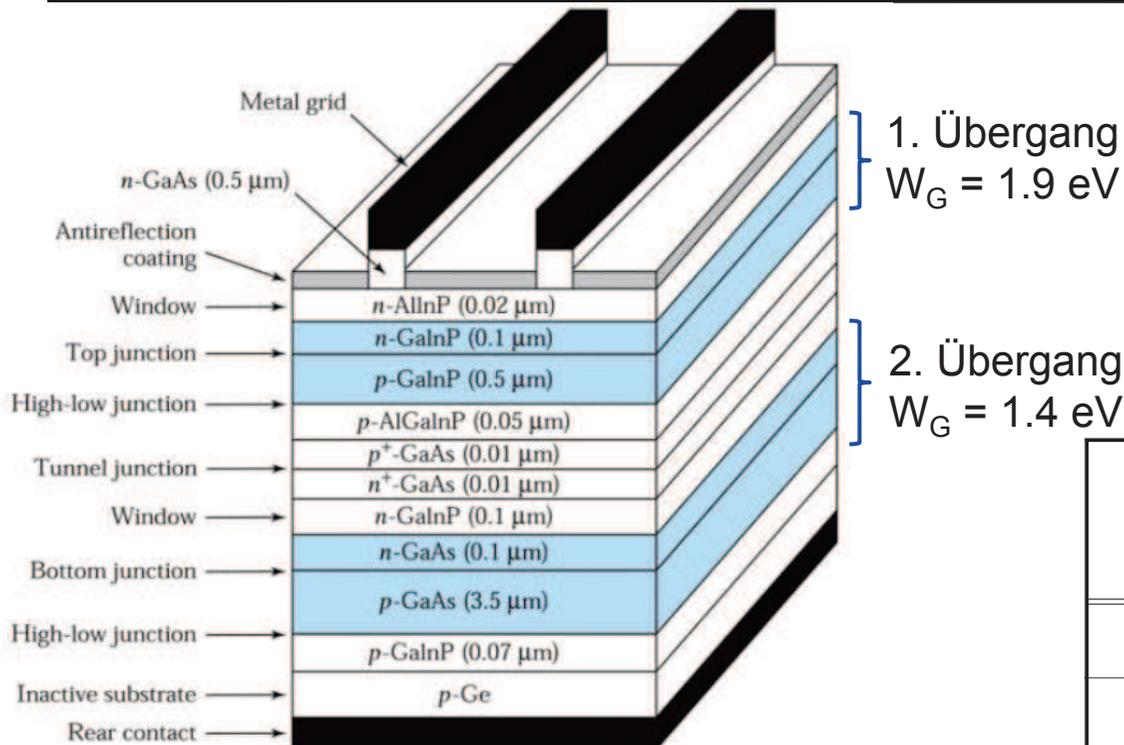
Tandem-Solarzelle: Verbindung von zwei  $p-n$ -Übergängen mit verschiedenen Bandlücken
