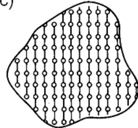
**Kristalliner Festkörper:** Bausteine (Atome, Ionen oder Moleküle) sind regelmäßig in einer Kristallstruktur angeordnet (Nah- und Fernordnung).
