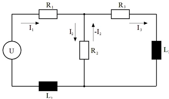
Bestimmen Sie unter Verwendung der Kirchhoff'schen Regeln ein Differentialgleichungssystem für die Ströme  $I_2$  und  $I_3$ . Lösen Sie anschließend dieses System unter den Anfangsbedingungen  $I_1(0) = I_2(0) = I_3(0) = 0$  und mit den Größen  $R_1 = R_2 = R_3 = 10$ ,  $L_2 = L_3 = 10H$ ,  $U = 10 \sin(t) V$ .
