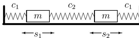
bestehend aus zwei Massen  $m > 0$ , die mit einer Feder der Federkonstanten  $c_2 > 0$  aneinander gekoppelt und jeweils durch Federn (mit Federkonstante  $c_1 > 0$ ) an der linken bzw. rechten Wand befestigt sind.
