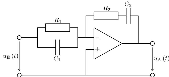
Bestimmen Sie die Übertragungsfunktion  $G(s) = \frac{U_A(s)}{U_E(s)}$  der Eingangsspannung  $\mathcal{L}\{u_E(t)\} = U_E(s)$  zur Ausgangsspannung  $\mathcal{L}\{u_A(t)\} = U_A(s)$ . Der Ausgang sei wie in der Schaltung angegeben unbelastet, zu Beginn der Betrachtung seien alle Kondensatoren ungeladen und der Operationsverstärker verhalte sich optimal.
