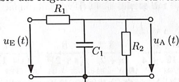
Es gelten die nominierten und direkt einsetzbaren Bauteilwerte:  $R_1 = 2, R_2 = 1, C_1 = \frac{1}{2}$ .
