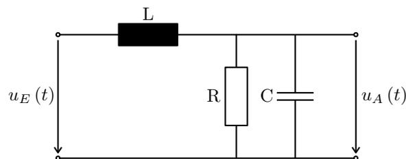
Der Kondensator ist zum Zeitpunkt  $t = 0$  geladen, womit sich  $u_C(-0) = 2$  ergibt. Bestimmen Sie den Verlauf der Ausgangsspannung  $u_A(t)$ , wenn  $u_E(t) = \sigma(t)$  gilt. Die Bauteilwerte  $L = 1$ ,  $R = 5$ , und  $C = 0,1$  sind bereits normiert und können direkt eingesetzt werden.
