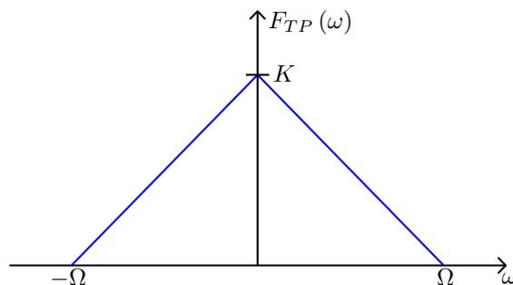
Berechnen Sie die Filterfunktion  $f_{TP}(t)$  im Zeitbereich.
