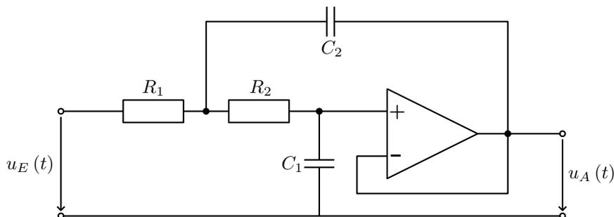
Betrachten Sie hierbei  $u_E(t)$  als Eingangsgröße des Systems und  $u_A(t)$  als Ausgangsgröße. Sie können die üblichen, am Operationsverstärker gültigen, Vereinfachungen nutzen. Die Kondensatoren seien zum Zeitpunkt  $t = 0$  ungeladen.
