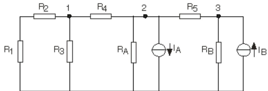
$$\begin{bmatrix} \frac{1}{R_1+R_2} + \frac{1}{R_3} + \frac{1}{R_4} & -\frac{1}{R_4} & 0 \\ -\frac{1}{R_4} & \frac{1}{R_4} + \frac{1}{R_A} + \frac{1}{R_5} & -\frac{1}{R_5} \\ 0 & -\frac{1}{R_5} & \frac{1}{R_5} + \frac{1}{R_B} \end{bmatrix} \begin{bmatrix} U_1 \\ U_2 \\ U_3 \end{bmatrix} = \begin{bmatrix} 0 \\ -I_A \\ I_B \end{bmatrix}$$
