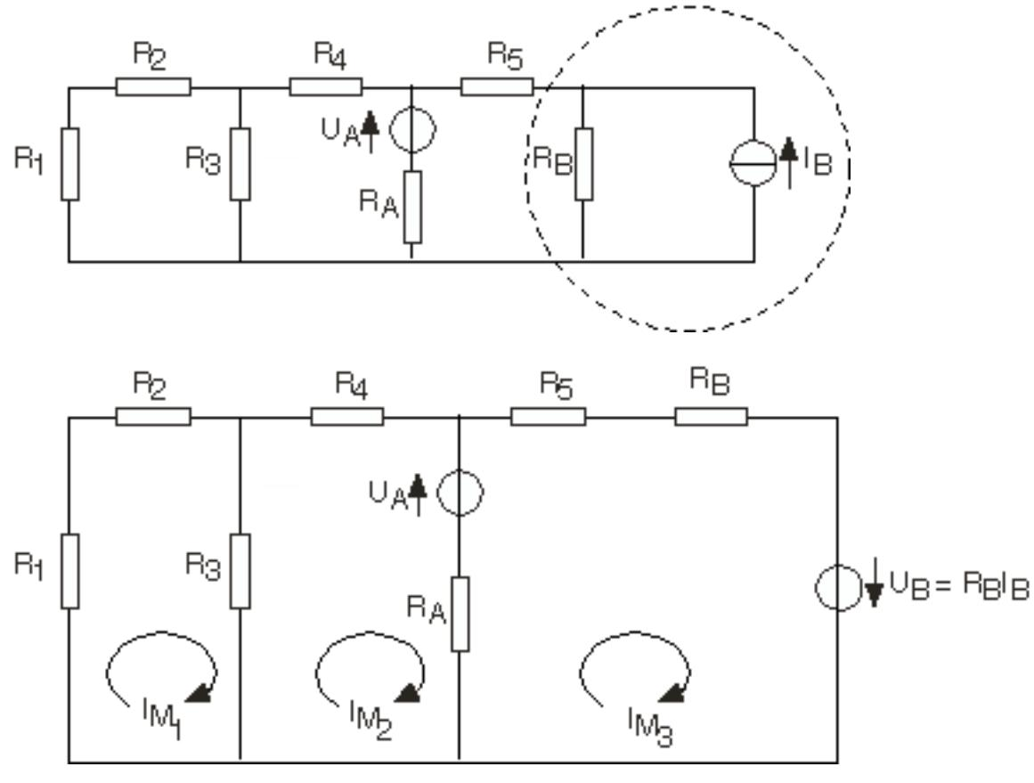
$$\begin{bmatrix} R_1 + R_2 + R_3 & -R_3 & 0 \\ -R_3 & R_3 + R_4 + R_A & -R_A \\ 0 & -R_A & R_A + R_5 + R_B \end{bmatrix} \begin{bmatrix} I_{M1} \\ I_{M2} \\ I_{M3} \end{bmatrix} = \begin{bmatrix} 0 \\ U_A \\ -(U_A + R_B I_B) \end{bmatrix}$$
