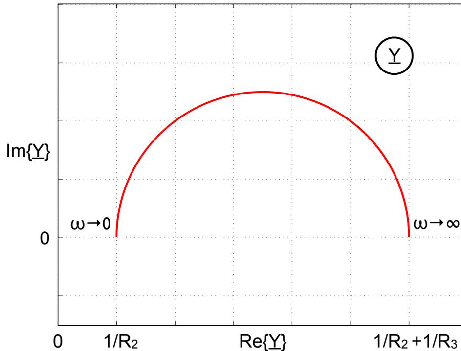
d) Wenn  $R_3$  vergrößert wird, wird der Radius der Admittanzkurve kleiner, der Realanteil für  $\omega \rightarrow \infty$  wird kleiner, der Realanteil für  $\omega \rightarrow 0$  bleibt unverändert
