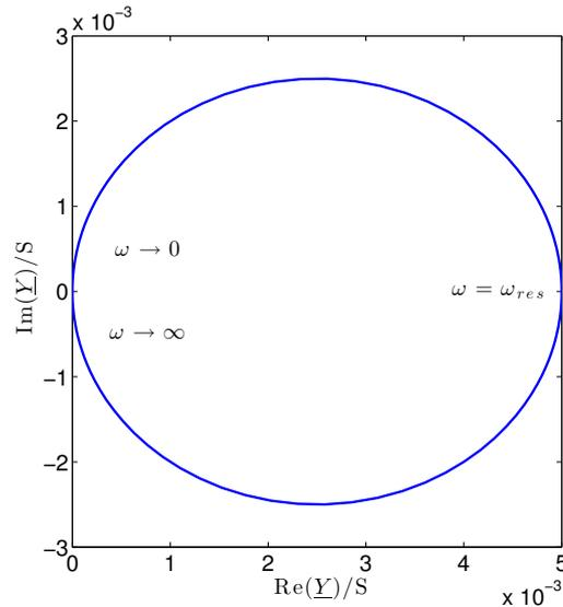
(Auch die Skalierung der imaginären Achse eintragen, Kennzeichnung des Verhaltens für  $\omega$  gegen 0 und  $\infty$ .)
