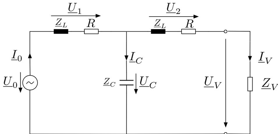
An dem Verbraucher liegt die Spannung  $\underline{U}_V = 6 \text{ kV}$  (Effektivwert). Der in den Verbraucher fließende Strom beträgt  $\underline{I}_V = (30 - j10) \text{ A}$  (Effektivwert).
