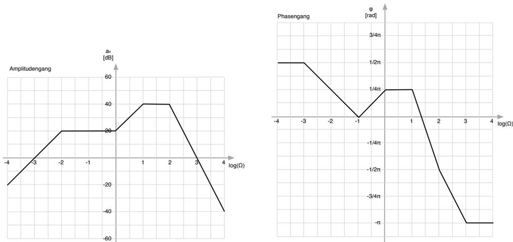
Im Folgenden soll die Übertragungsfunktion der dargestellten Schaltung rekonstruiert werden. Es sollen dafür nur Filter erster Ordnung eingesetzt werden. Zerlegen Sie die Schaltung in fünf Teilschaltungen und einen Verstärkungsfaktor. *Hinweis: Gehen Sie von entkoppelten Schaltungsteilen aus.*
