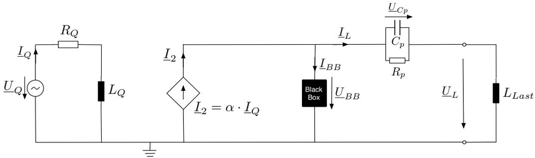
In dieser Schaltung befindet sich eine Black Box. Von dieser Black Box sind die darüber abfallende Spannung  $\underline{U}_{BB}$  und der hinein fließende Strom  $\underline{I}_{BB}$  bekannt:
