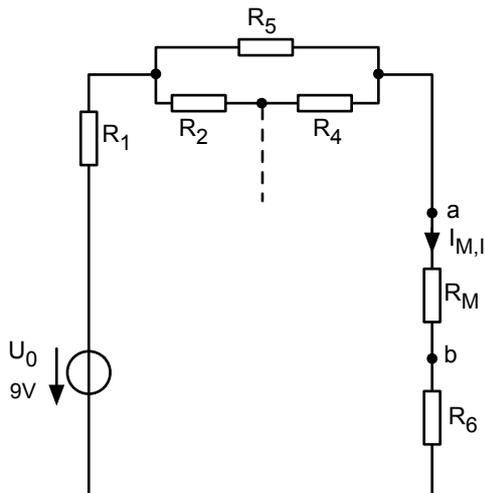
Abb. 3: Resultierendes Teilnetzwerk I nach der Unterbrechung des Strompfades mit der Stromquelle  $I_0$ .
