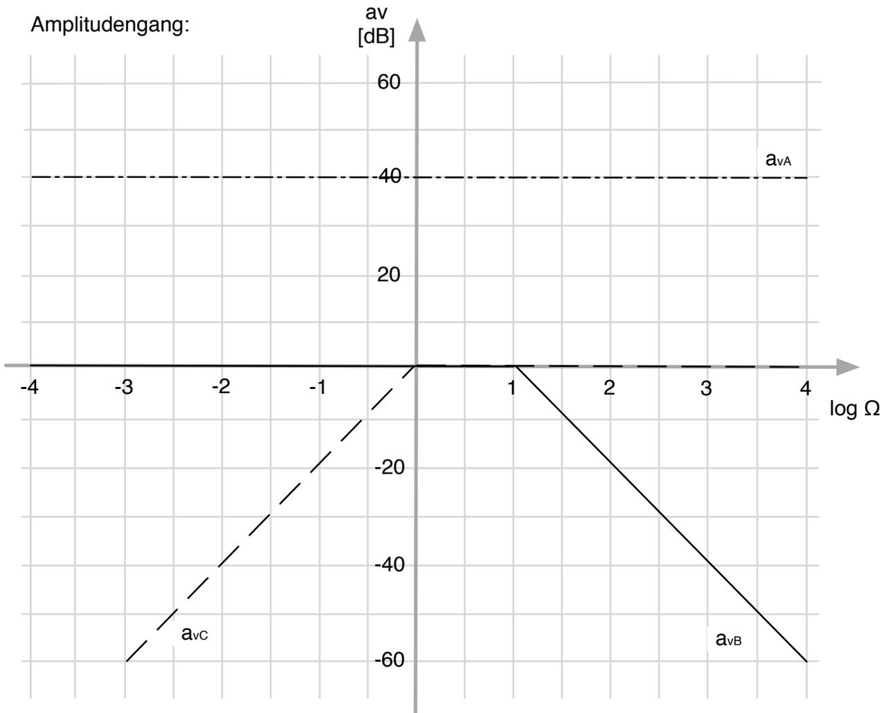
$$\frac{a_{v,A}}{\text{dB}} = 20 \log \left| \frac{100k\Omega + 1k\Omega}{1k\Omega} \right| \approx 40$$
