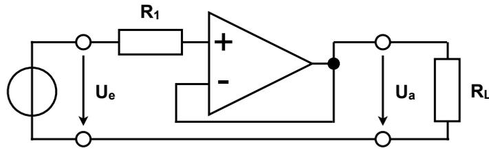
b) Durch die Betriebsspannung. Die Ausgangsspannung kann nicht größer sein als die Betriebsspannung.
