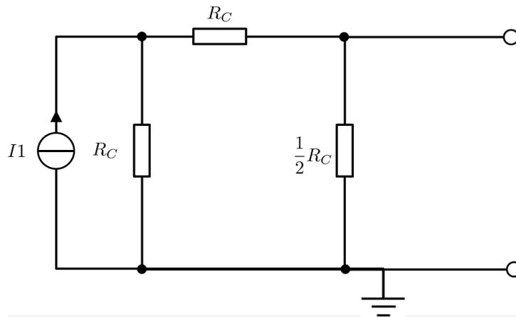
Anschließend wandeln wir wieder die Stromquelle in eine Spannungsquelle um.
