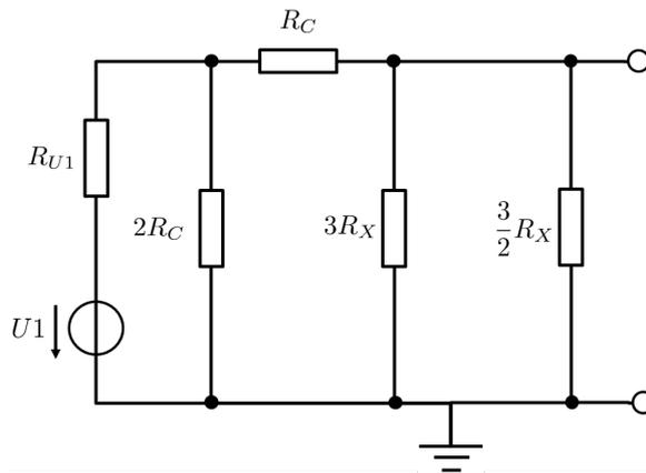
Und schließlich kann noch die Parallelschaltung von den Widerständen mit  $3R_X$  und  $\frac{3}{2}R_X$  berechnet werden.
