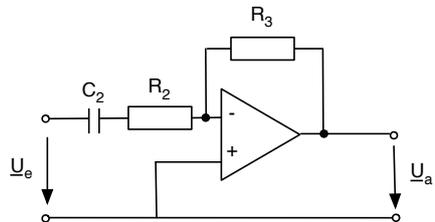
Die resultierende Schaltung ist eine Kette aus Tiefpass, Spannungsfolger und Hochpass:
