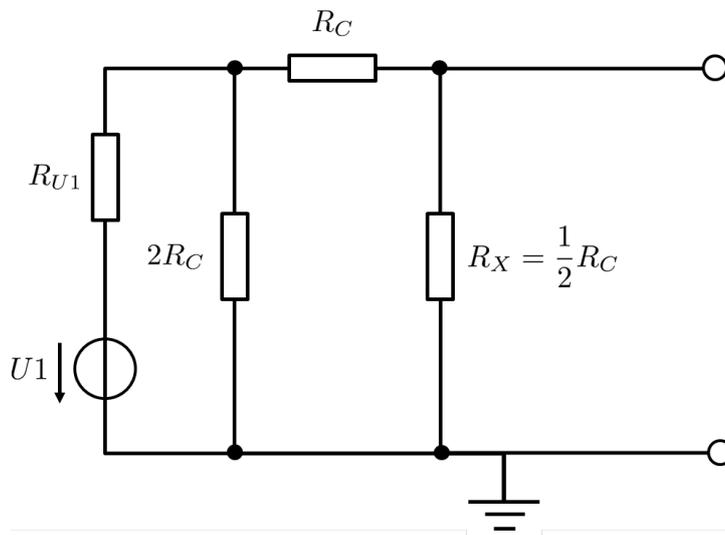
Für die äquivalente Spannungsquelle benötigen wir den Gesamtwiderstand der Schaltung. Wir ersetzen  $R_{U1}$  durch  $100\ \Omega$  oder eben durch  $2R_C$ . Damit lässt sich die Spannungsquelle in eine Stromquelle umwandeln.
