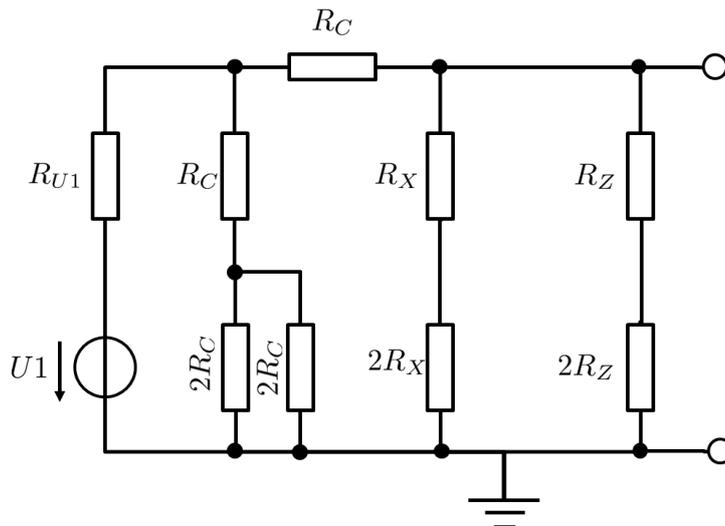
Im nächsten Schritt können die beiden Serienschaltungen von  $R_X$  und  $R_Z$  angegeben werden. Auch die kleine Schaltung aus Serien- und Parallelschaltung von  $R_C$  lässt sich leicht angeben.
